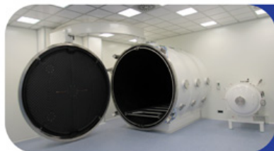
Camera Termovuoto per ciclaggi termici di componenti per Satelliti
