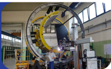
Criostato di grosse dimensioni per test dei magneti per ITER
